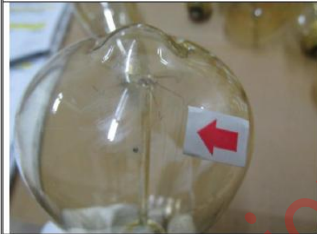
Dirty mark -Minor
