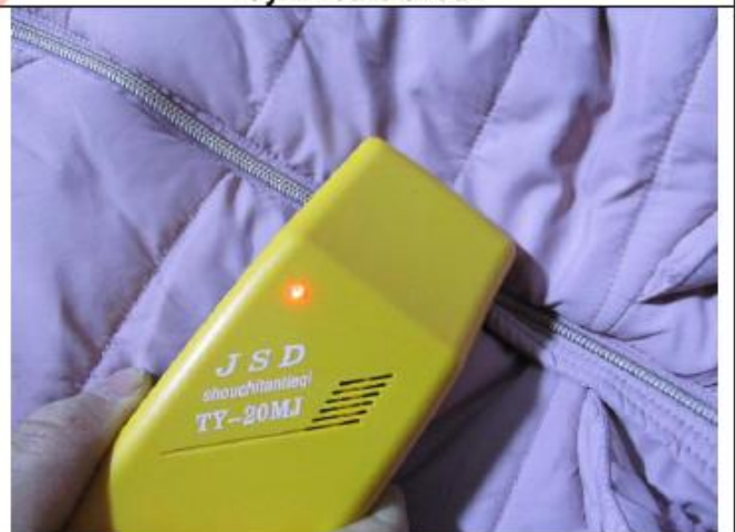
Metal detecting test (metal puller)
